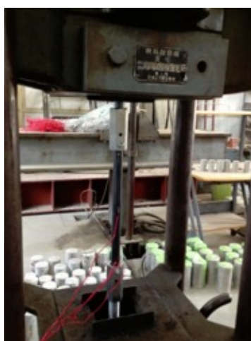
写真 11 加工した鉄筋の引張試験
