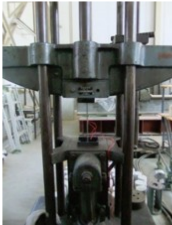
写真7 鉄筋引張実験
