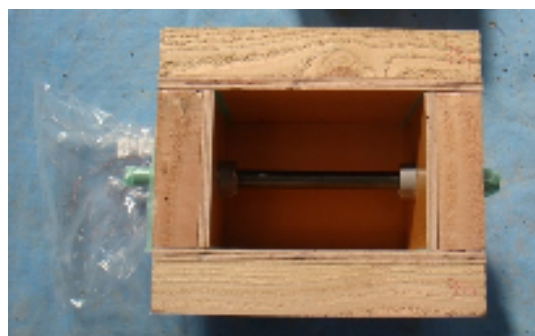
写真 3 局所付着用試験体型枠
