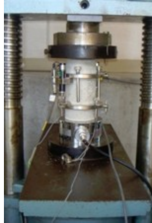
写真8 コンクリート圧縮・割裂実験
