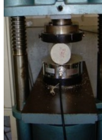
写真8 コンクリート圧縮・割裂実験
