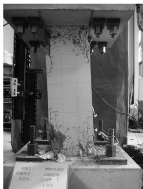
写真 1-1-1 せん断破壊先行型試験体の破壊性状 5)
