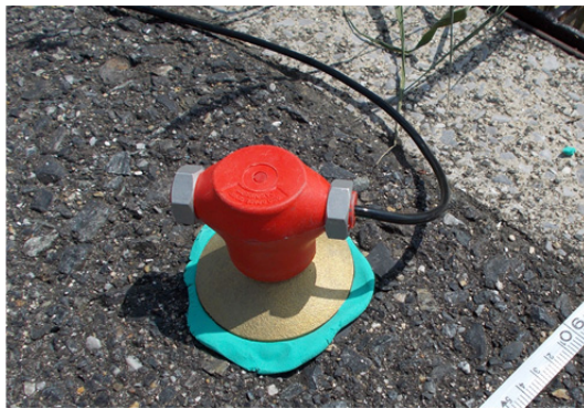
写真 6.5 受振器設置状況
