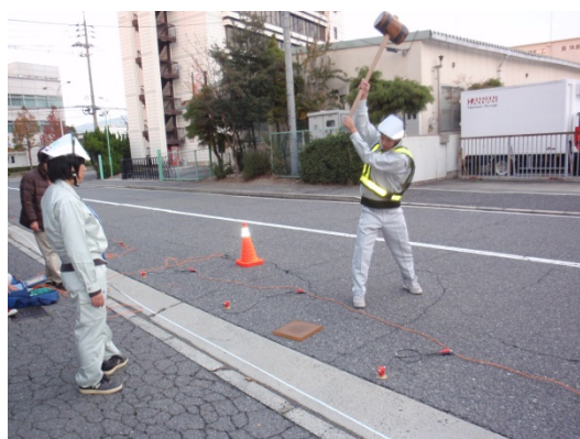
写真 6.9 カケヤによる起振状況
