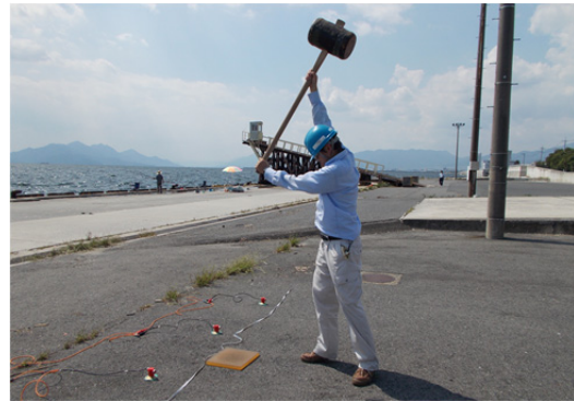
写真 6.4 カケヤによる起振状況
