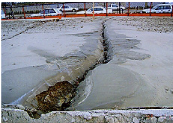
写真 2.11 西宮市甲子園浜町付近の噴砂後の状況 14)
