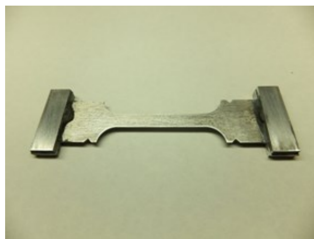
Fig. 2.3 アルミ板を取り付けた試験片
