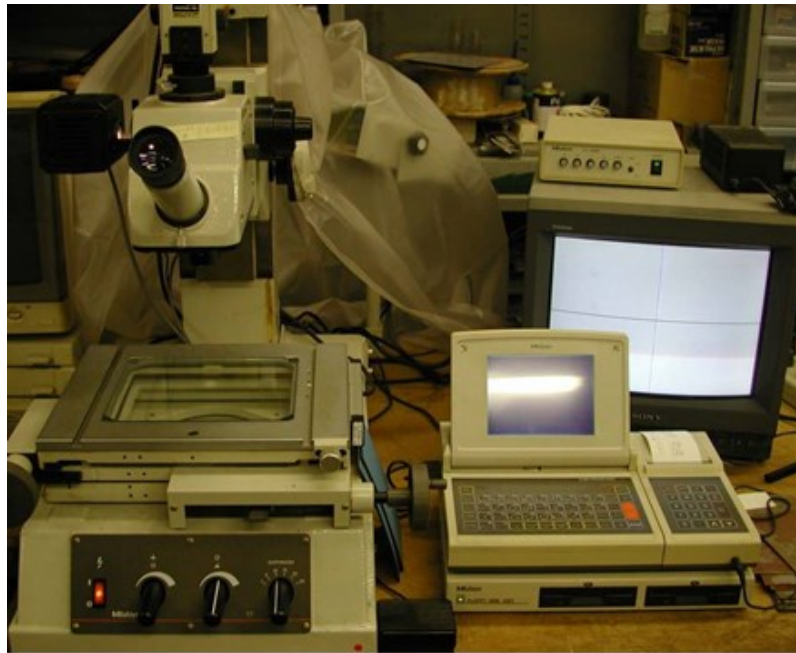
Fig. 5.4 スクライブドサークルの実測に用いた計測機器
