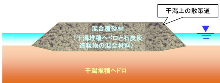
図-7.4.9 混合覆砂材による散策道構築の概要
