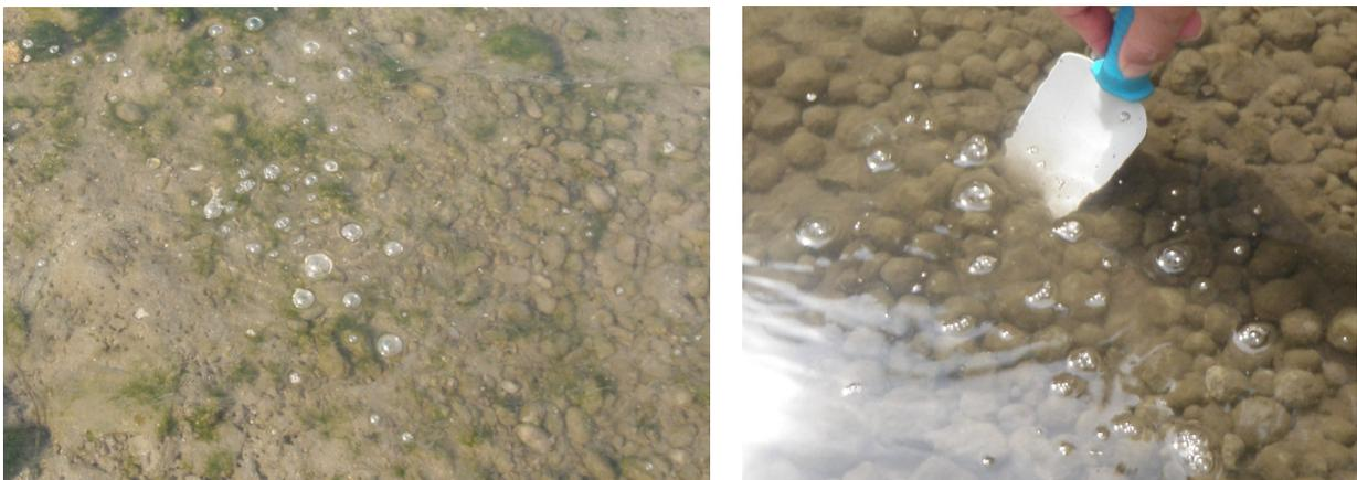
写真-4.2.2 石炭灰造粒物による覆砂部からの発泡状況（干出前）
