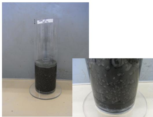
写真-4.2.1 石炭灰造粒物層内に泥が堆積した様子
