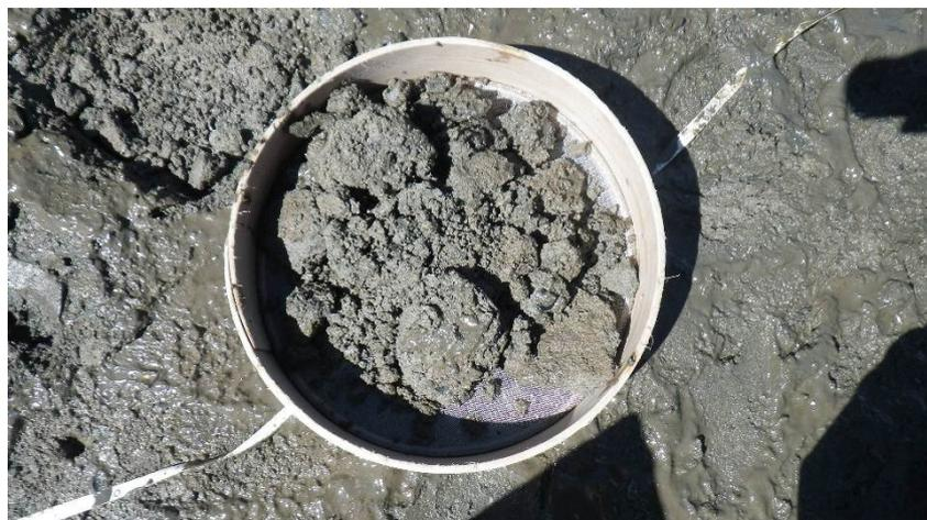
写真-4.5.5 混合後4年半経過した固結有機泥(天満川)
