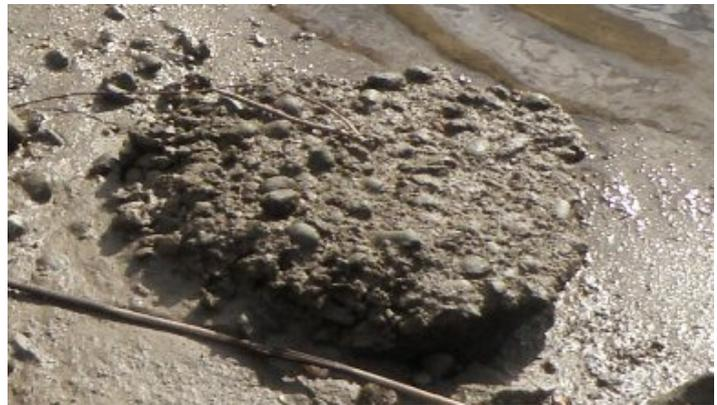
写真-4.5.3 微細粒子による石炭灰造粒物の凝結状況
