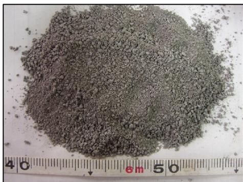
写真-5.4.1 分級した石炭灰造粒物<sup>11)</sup>
