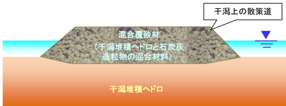
図-4.5.7 混合覆砂材による散策道構築の概要
