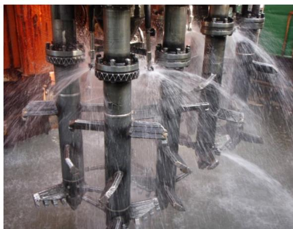
写真-4.5 CDM改良軸の先端(改良軸8本)
