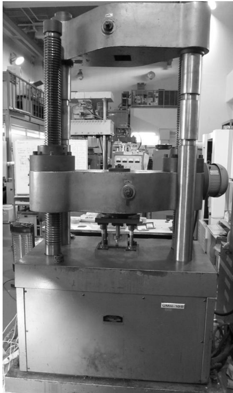
図 4.1 U 曲げ実験装置全体像 (アムスラー式ユニバーサル試験機)
