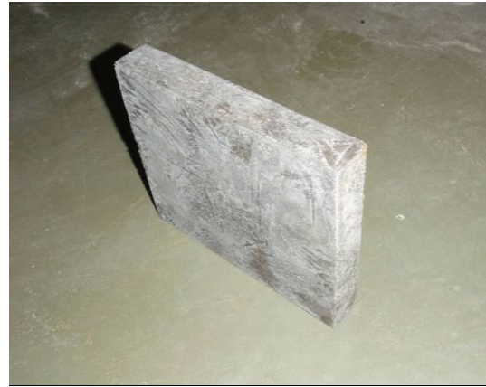
図 5-3-8 鉄鋼スラグ改良壁（凍結後）
