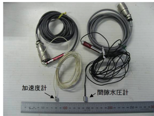
図 5-3-22 加速度計と間隙水圧計
