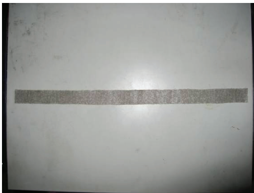
図 5-3-13 不織布による帯状ドレーン
