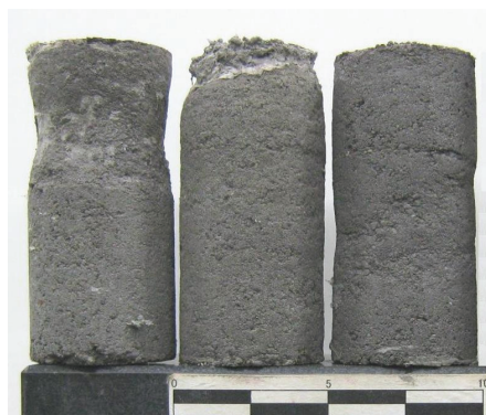
図 2-3-28 繰返し载荷試験後の供試体の状況 22)
