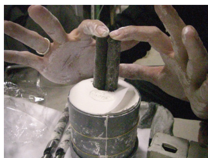
図 3-3-11 杭を差し込む
