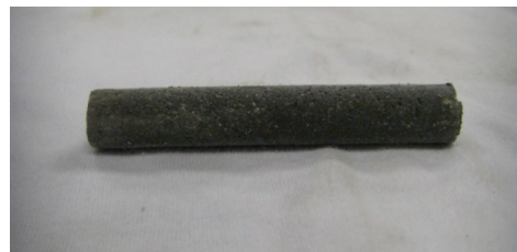
b) 鉄鋼スラグ杭
