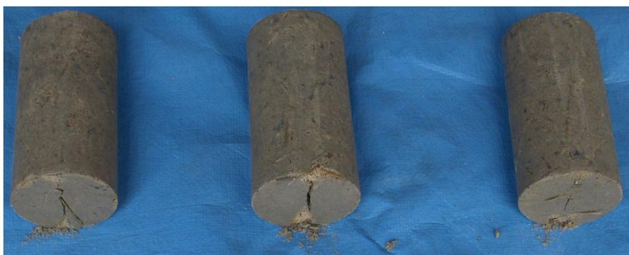
(b) 供試体 M3 の破壊模様 (セメント 200kg/m<sup>3</sup>、竹繊維 1.0%)
