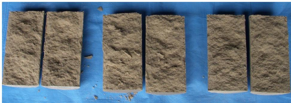
(a) 供試体 L3 の破壊模様 (セメント 200kg/m<sup>3</sup>、竹繊維 0.0%)
