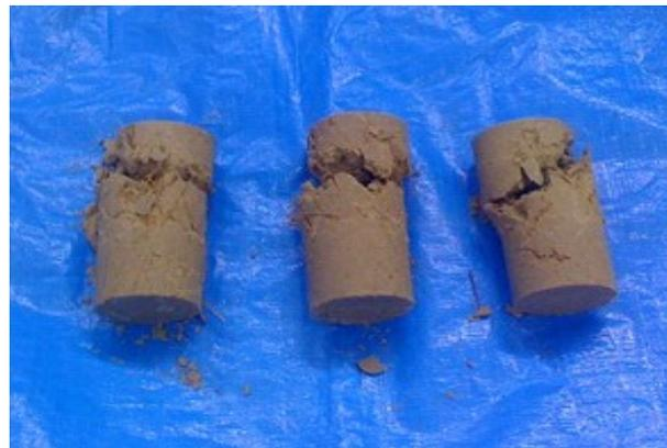
図 5-26 供試体の破壊模様
