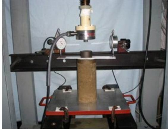
図 5-23 圧縮試験装置
