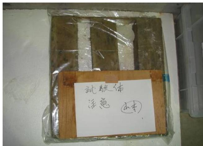
図 5-7 曲げ供試体の養生の様態
