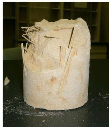
供試体 F(b)の破断面
