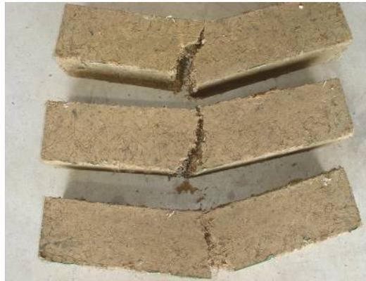
図 5-11 曲げ供試体の破壊の様相
