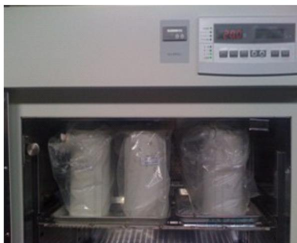
図 5-22 圧縮供試体の養生中の模様
