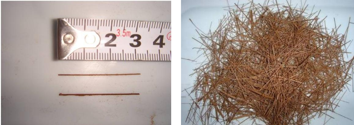
図 5-5 竹繊維試料（長さ 30mm×太さ 0.4mm）
