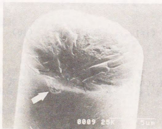
図3-2. アルミニウム被覆後、700°C、0.5min間焼鈍処理したSiC繊維の破面
