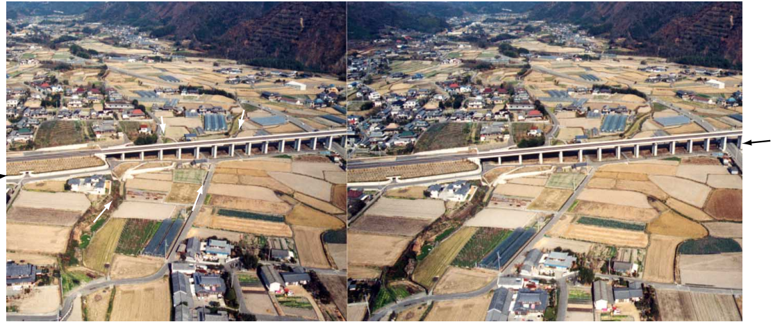
図13-1 34.9～35.3付近における変位地形の斜め空中写真(実体視写真) 黒矢印は断層を示し、白矢印は段丘崖のずれを示す。断層の直上に徳島自動車道が建設された。
