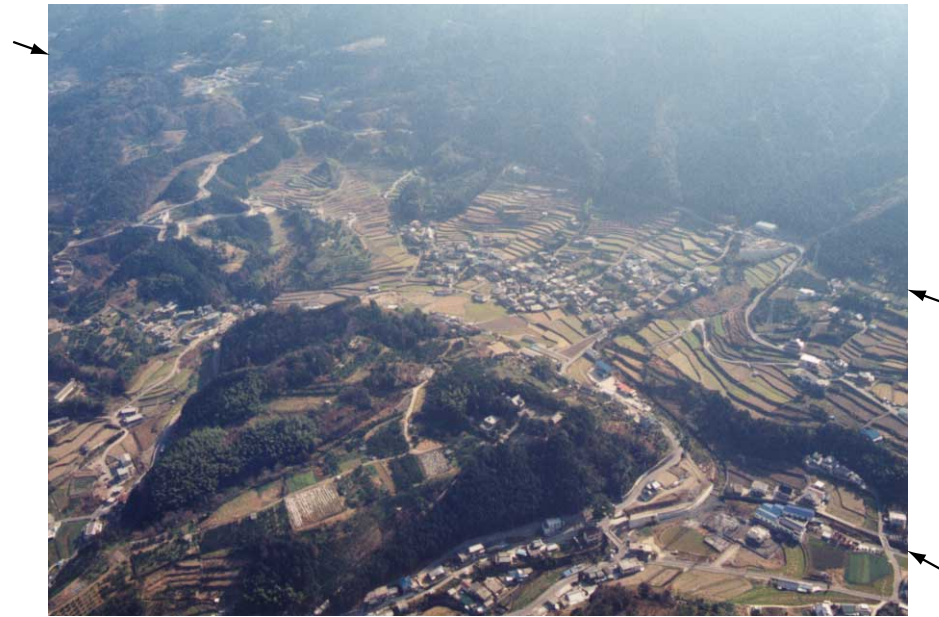
図37-1 97.6～99.2付近の斜め空中写真 矢印は断層を示す。2条の断層の間には沖積面が広がる。
