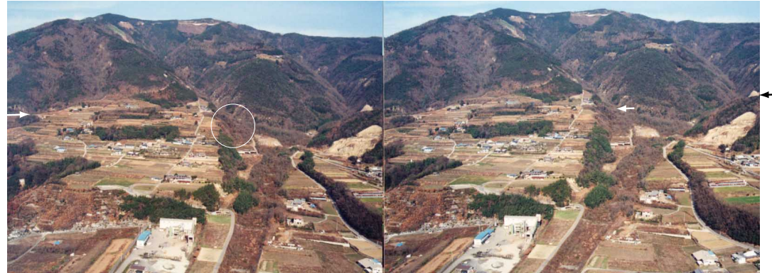
図23-1 60.1～61.1付近における変位地形の斜め空中写真(実体視写真) 矢印は断層を示す。上野付近の段丘面の盛り上がり、高瀬川右岸の段丘崖の右ずれ(円の中)をみることが出来る。
