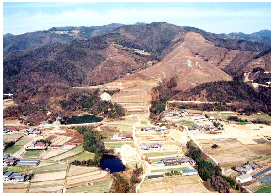
図19-2 51.0～51.8付近の斜め空中写真 系統的な河谷の屈曲と鞍部列が認められる。
