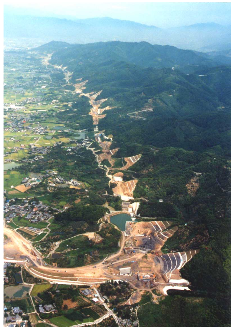
図 71-3 188 地点上空から北東方向を撮影した斜め空中写真 直線的な山麓線に沿って伊予断層が発達する。松山自動車道が断層の直上に建設された。
