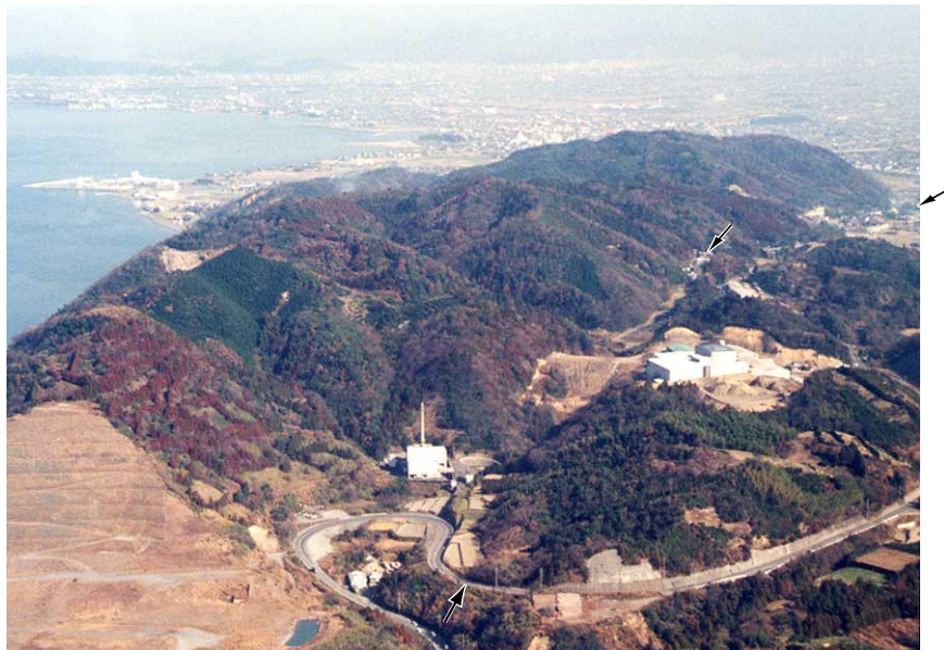
図 79-1 19.0 付近上空から北東を撮影した斜め空中写真 伊予断層は直線状谷を通過する。
