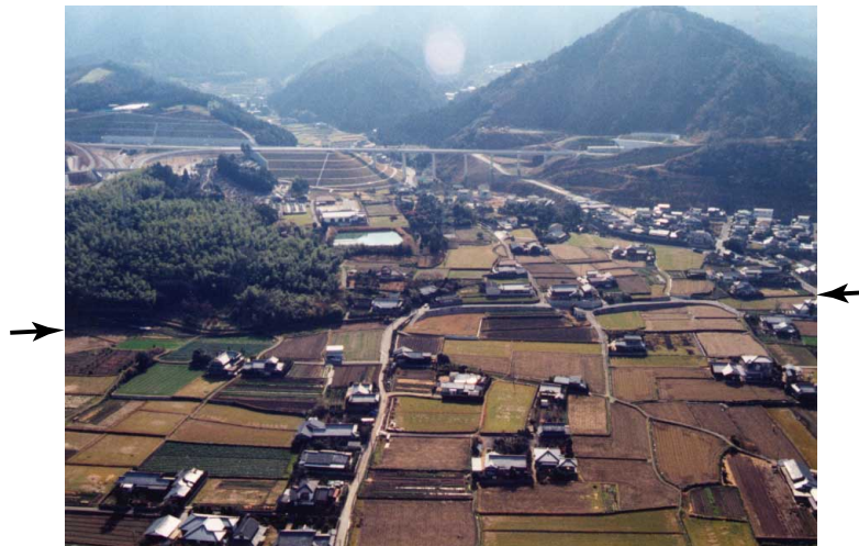
図 53-2 133.0～133.5の斜め空中写真 断層は段丘面を変位させ、直線状に延びる。古い段丘面ほど変位量は大きい。
