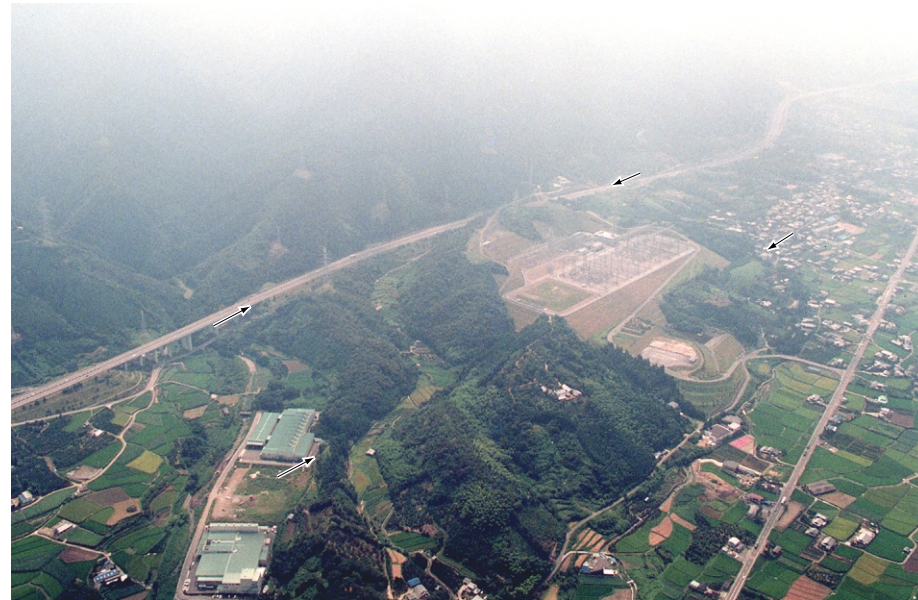
図45-2 高位面を開析する谷の屈曲(117.2～118.7付近) 矢印は断層の位置を示す。
