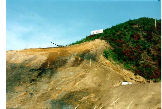
図 33-1 Loc.Sa-1 (89.42) の佐野断層の断層露头写真 矢印は断層の位置を示す。
