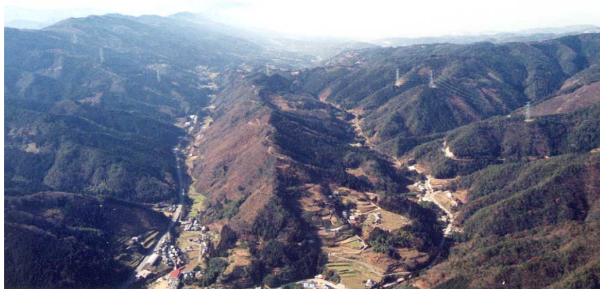
図 33-2 88.5 付近上空から西方向の斜め空中写真 中央構造線に沿った直線的な山麓線とその北に位置する佐野断層の変位地形をみることができる。
