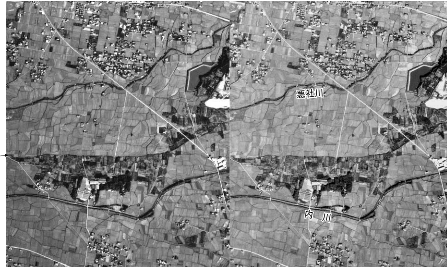
図72-1 171.8～173.3の空中写真 矢印は断層を示す。国土地理院撮影 SI-67-3X, C13-9～10 を使用
