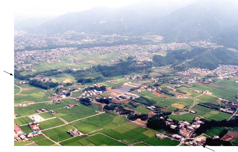
図51-1 129.5～130.2付近の斜め空中写真 扇状地面を切断する低断層崖が連続する。
