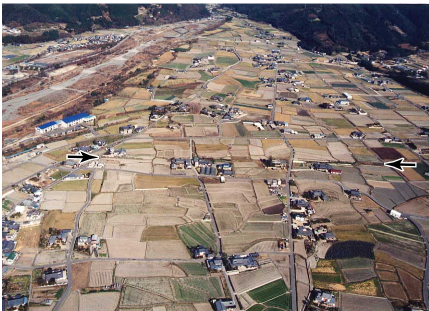
図 70-2 166.8 ~ 167.5 の斜め空中写真 沖積扇状地を切断する低断層崖が直線的に延びる。
