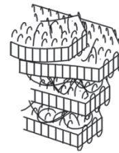
結晶性高分子における 結晶・非晶の積層構造
