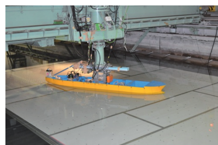
Figure : 広大水槽の浅水設備と模型船を用いた浅水域試験の様子
