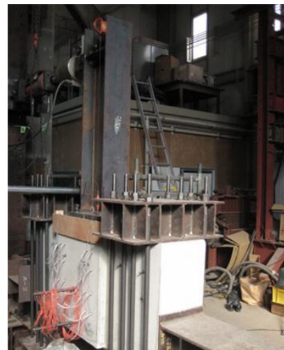
写真 2. 4. 1 柱脚部の外観
