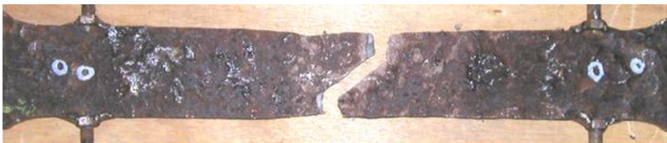
写真3.3.4 腐食平板の破断状態 (DF-2)
