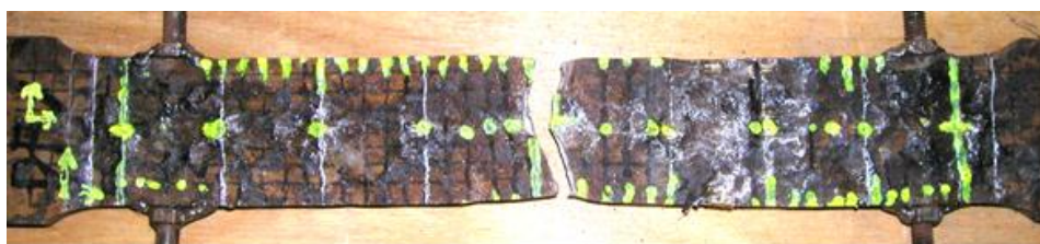
写真 3.3.3 腐食平板の破断状態 (DF-1)
