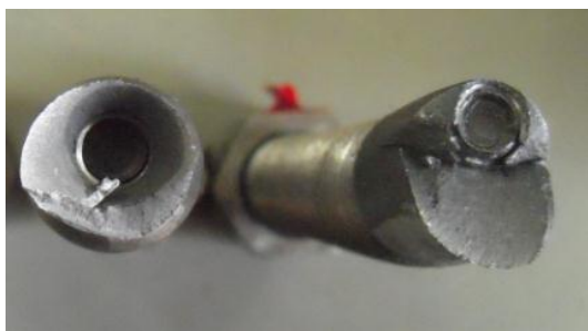
孔の偏心距離／ 左：0mm 右：5mm
