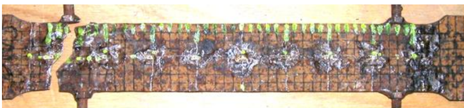
写真3.3.9 腐食平板の破断状態 (DW-3)
