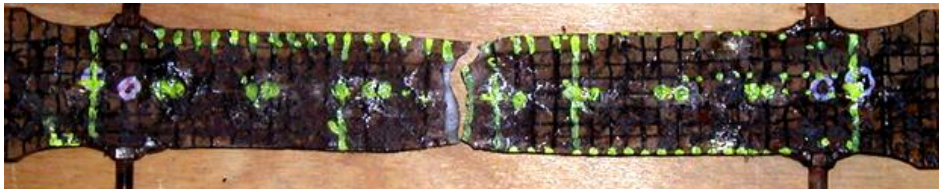
写真 3.3.6 腐食平板の破断状態 (DF-4)
