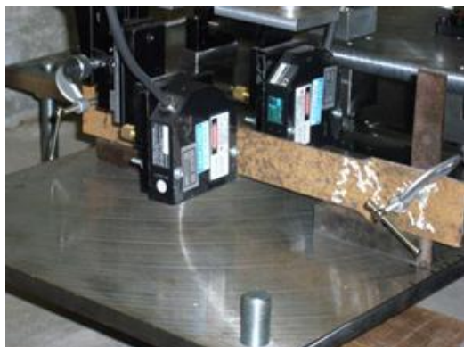
写真3.3.1 板厚計測状況
