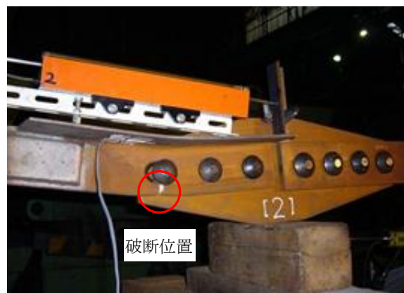
写真3.5.5 腐食なし試験体の破断状況 (第1ボルト孔位置で破断)
