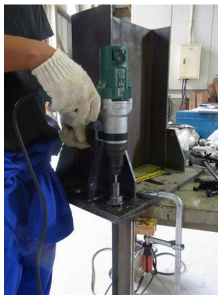
写真2.5.4 電動タップによるねじ切りの状況
