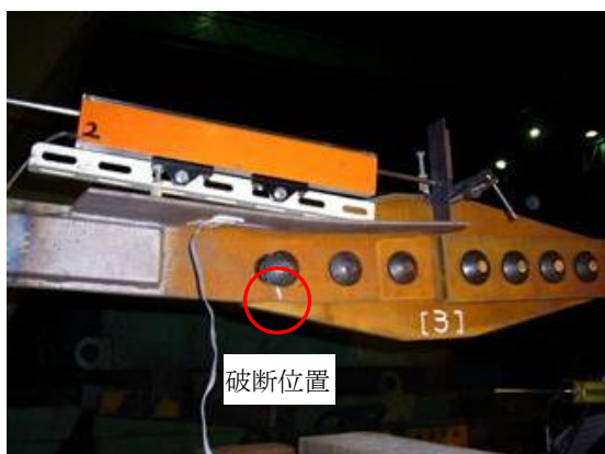
写真3.5.4 模擬腐食試験体の破断状況 (第1ボルト孔位置で破断)
