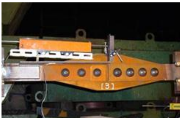
写真3.5.3 試験体取付状況 (模擬腐食試験体)
