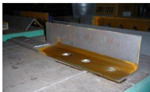
写真 3.5.2 腐食なし山形鋼外観 (減厚部分なし)
