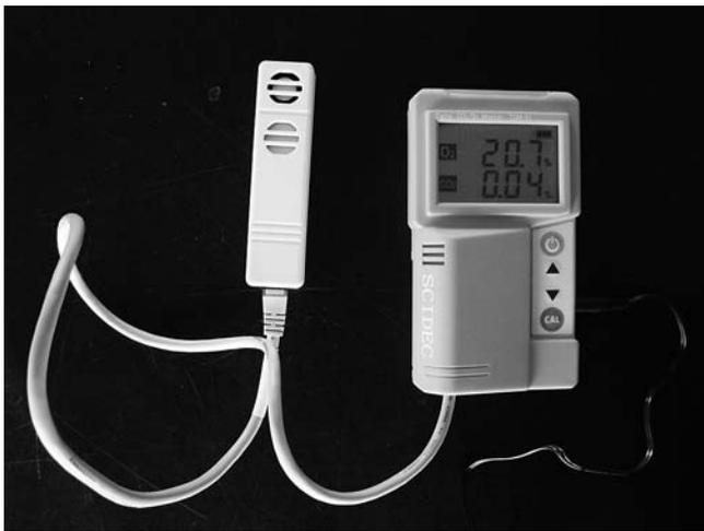
図5 可搬型CO<sub>2</sub>センサー
