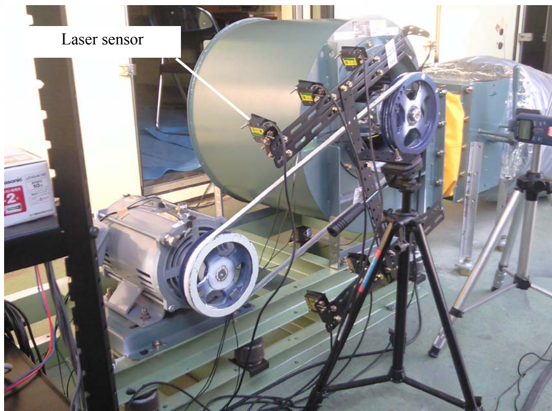
図 6.5 レーザーセンサによる測定状況
