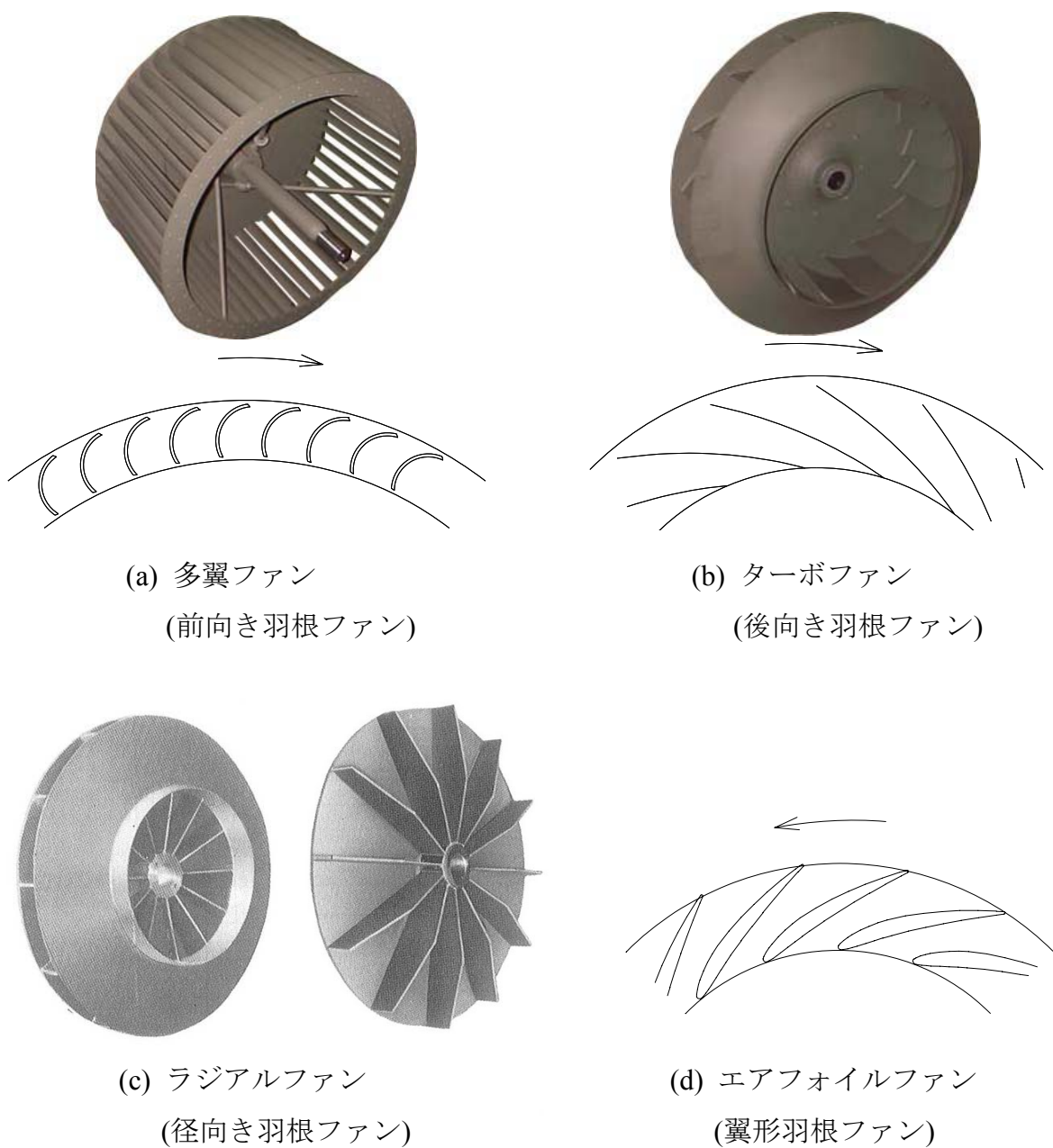
図 1.11 羽根車と羽根の形状
