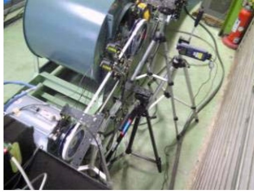
図 4.22 1本掛けベルト駆動の実験機
