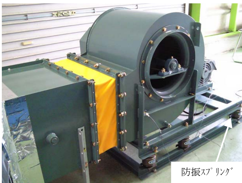
図 4.4 防振スプリング上に直接設置された実験機
