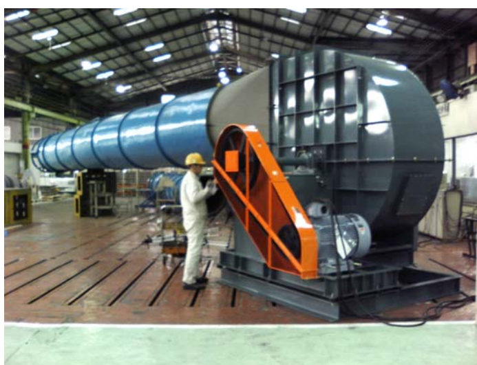
図 2.16 B9 タイプファンと試験状況の概観
