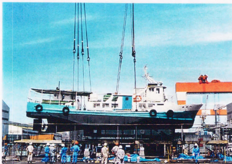
導電塗膜施工後の状況
