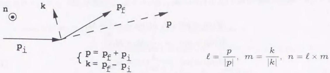
図 III.1: 散乱平面における  $\ell$ 、 $\mathbf{m}$ 、 $\mathbf{n}$  の定義。
