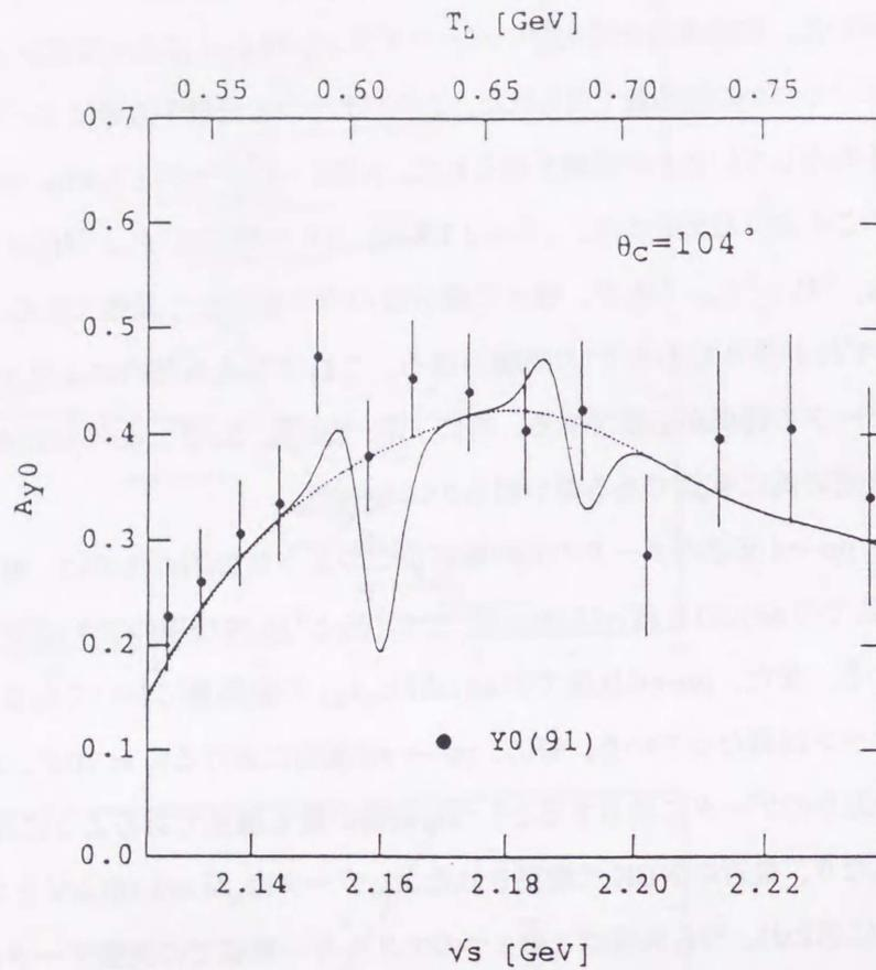
図IV.9  $pp - \pi d$ 反応における $\theta_c = 104^\circ(b)$ でのY0(91)のデータと ${}^3H_5$ 共鳴による計算値との比較。共鳴パラメーターは表IV-IIIの値を用いた。
