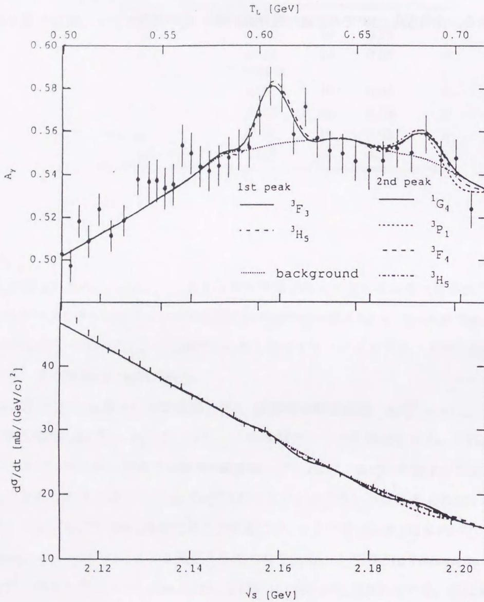
図IV.4 KEK- $A_y$ データの2つのピークに対する最適解での $A_y$ と $d\sigma/d\Omega(\theta_c = 90^\circ)$ の計算値と実験データの比較。 $\sqrt{s} = 2.16$ GeV辺りでは、実線が ${}^3F_3$ 、破線が ${}^3H_5$ を示し、 $\sqrt{s} = 2.19$ GeV辺りでは実線、小破線、破線、点破線は ${}^1G_4$ 、 ${}^3P_1$ 、 ${}^3F_4$ 、 ${}^3H_5$ を示し、点線はバックグラウンドを示す。共鳴パラメーターは表IV-IIIの値を用いている。
