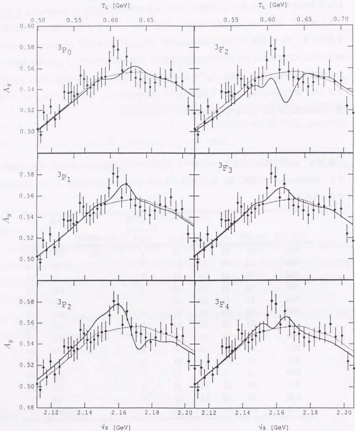
図IV.2 KEK- $A_y$ データ [Shi90, Kob94] と軌道角運動量  $\ell \leq 5$  のそれぞれの部分波に共鳴項  $R_{JP}$  を含めた式 (IV.7) により計算された  $A_y$  との比較。バックグラウンドを点線で、共鳴項を含めた計算値を実線で示す。共鳴パラメータは全ての部分波で  $\sqrt{s} = 2165 \text{ MeV}$ 、 $\Gamma_t = 10.0 \text{ MeV}$ 、 $x = \Gamma_{pp}/\Gamma_t = 0.08$  とした。
