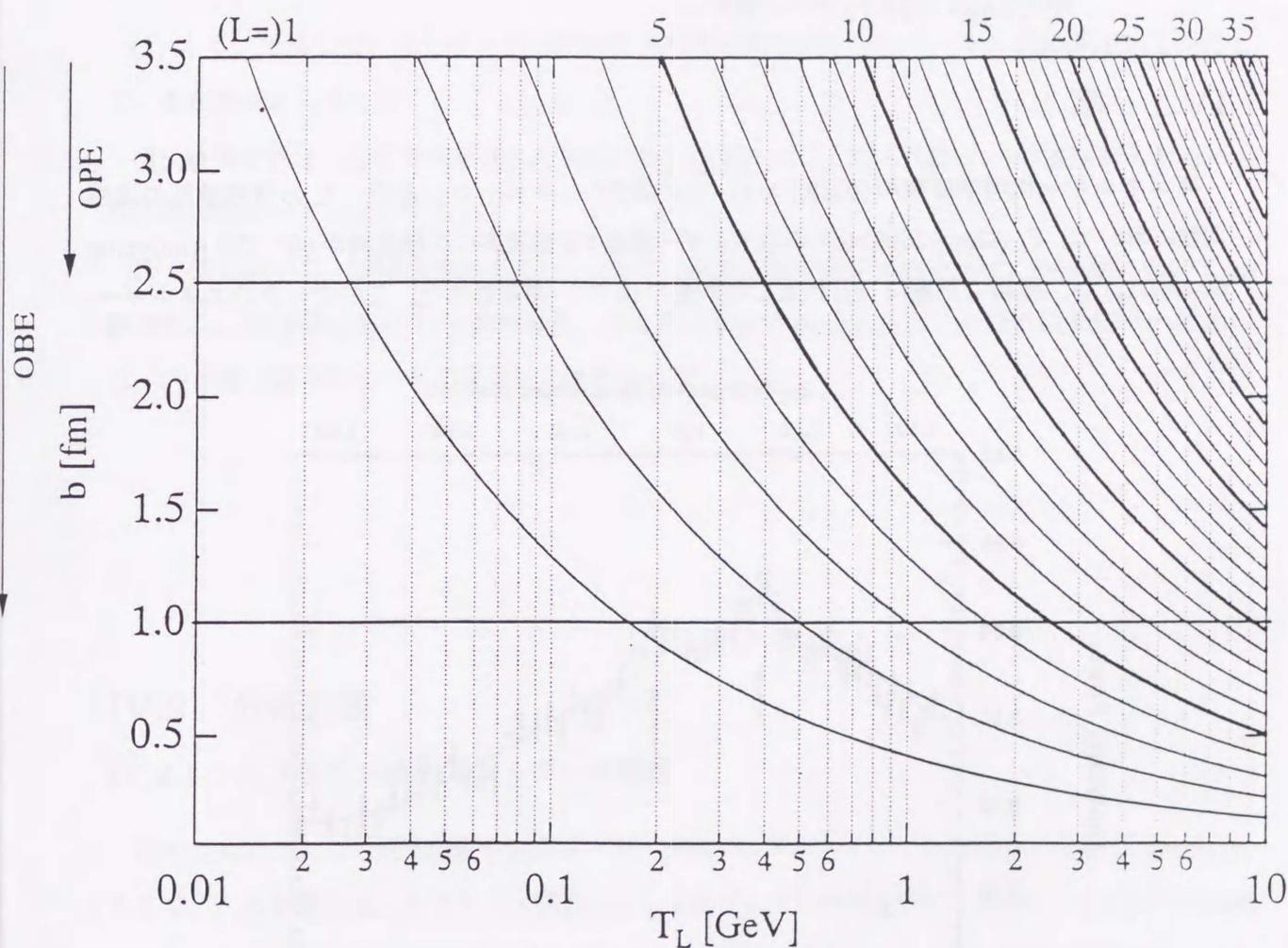
図III.5 インパクトパラメータとエネルギーとの関係。ここで、 $b$  : インパクトパラメータ、 $T_L$  : 入射運動エネルギーである。
