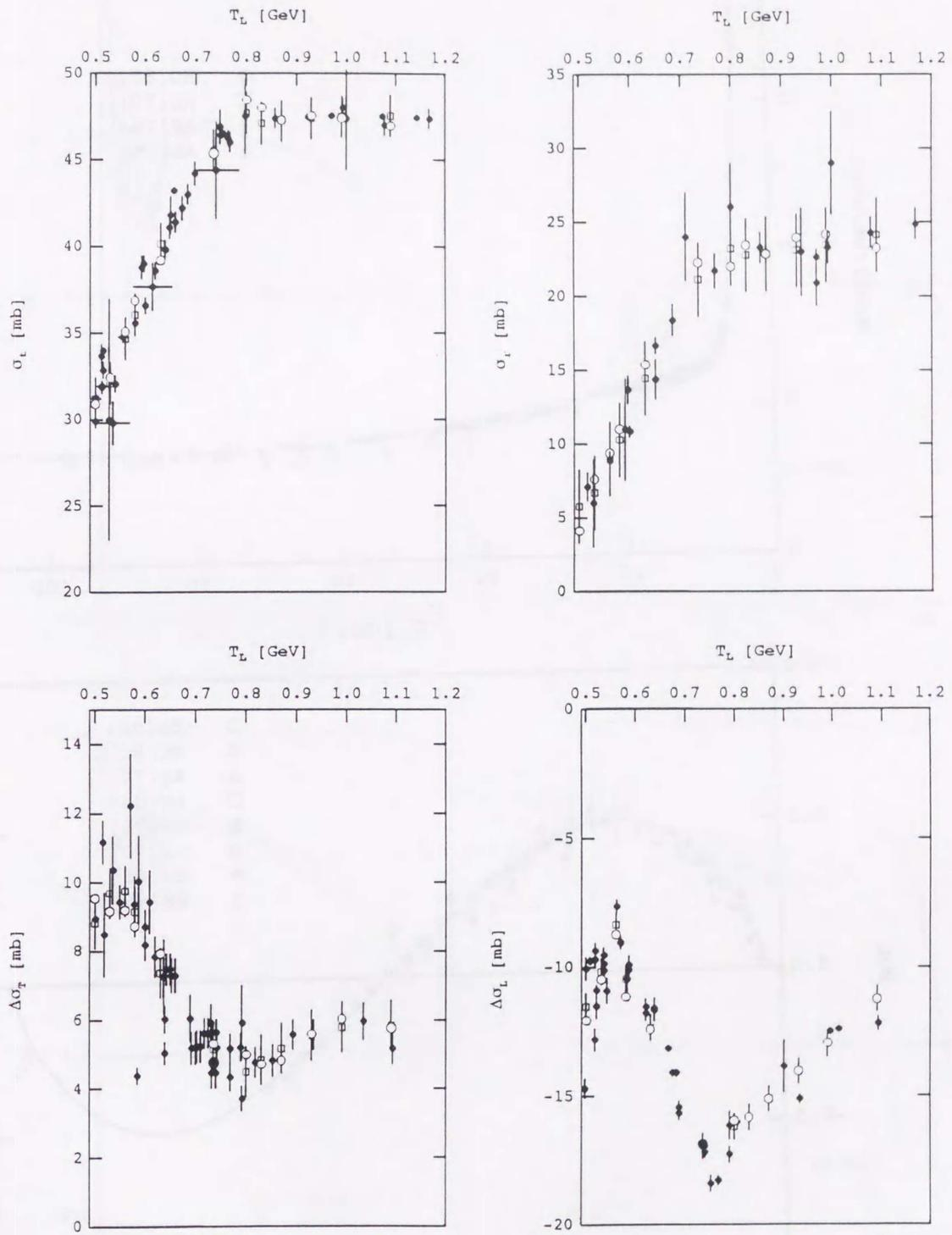
図 V.1 Forward observables の実験値[●] と位相差分析により得られた解[o] 及び位相差分析に用いた "pseudo data" (スプライン補間法により得た値)[□]。
