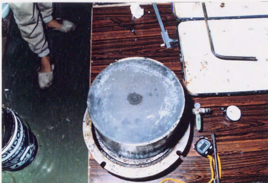
写真3. 3 (a) 模型地盤作成状況 (ST1を圧密容器から取り外した様子)
