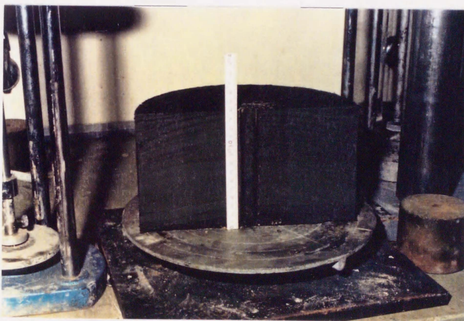
写真3. 3 (b) ST1の寸法測定 (2分割後, ドレーンを除去した状態)
