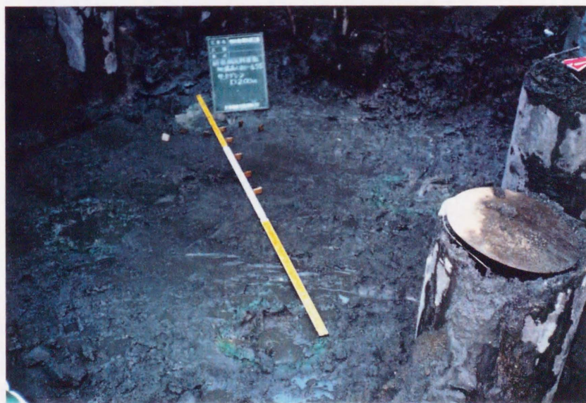
写真-2. 1 沖積粘性土の試料採取 (a)
