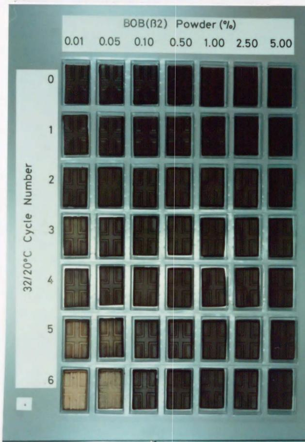
図5-8 粉末BOB結晶 ( $\beta_2$ 型) をシーディングした試料の温度サイクル試験 (32°C/20°C)
