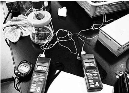
図8. ヒートテックの発熱現象を調べる実験。
