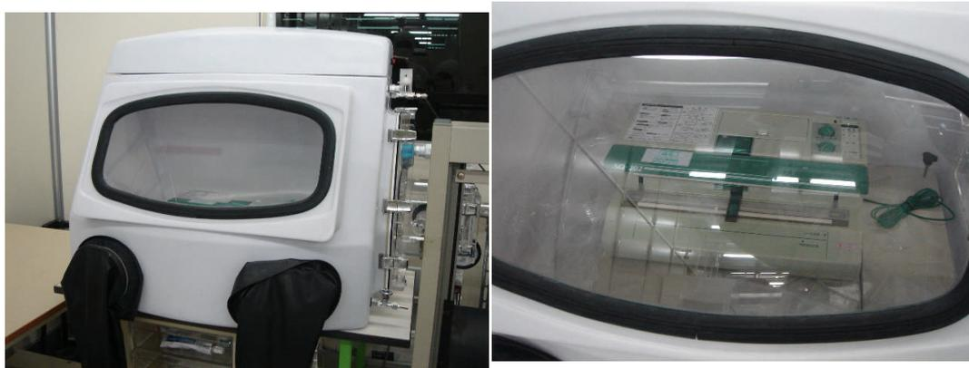
図5-12 簡易型のガスフロータイプのグローブ BOX とその内部にある簡易真空封止装置。
