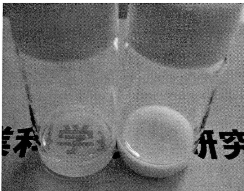
図 5-3 酸化チタン分散モノマー (左：ビーズミル分散，右：超音波分散)
