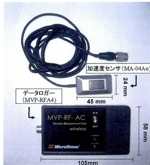
図9 3軸加速度センサおよび加速度データロガー
