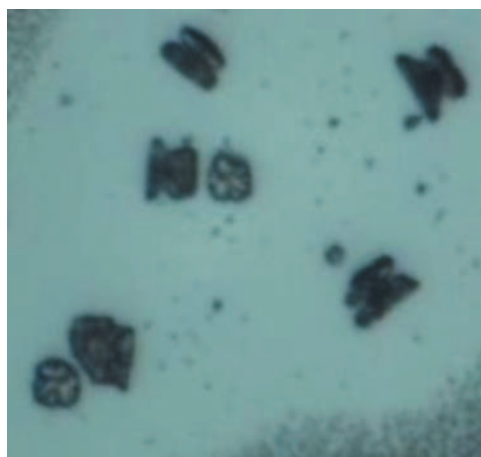
図2 直径数十nmの付着ゴミ粒子が、ガス成分を取り込んで数十～数百μmサイズの汚染に拡大してしまった例
