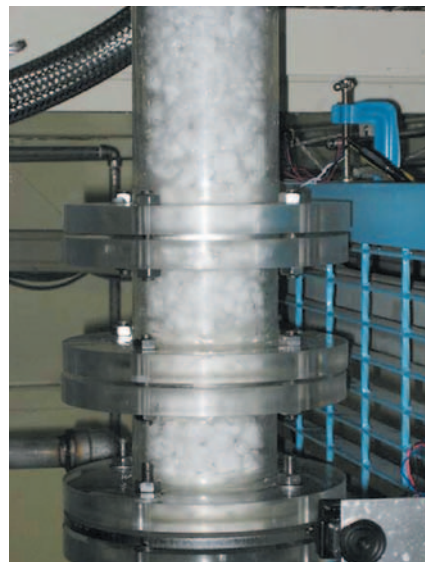
図7 ガスハイドレート充填層
