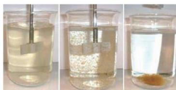
凝集沈殿による水
