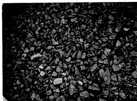
写真 3.5.1 瓦粗骨材
