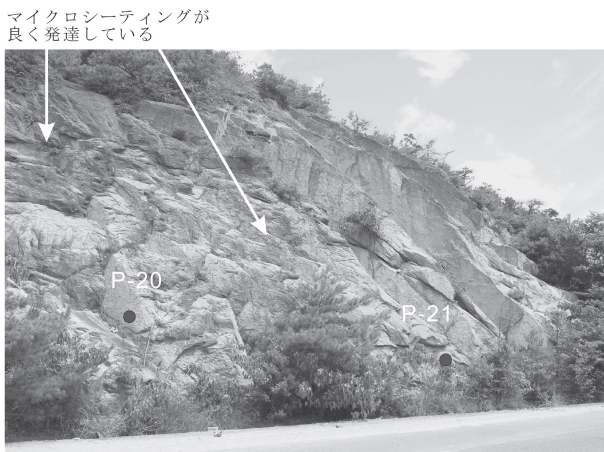
図7. 図4のさらに北東の露頭における花崗岩の風化状況。マイクロシーティングが厚く発達している。番号はシュミットハンマーの反発度の測定点。
