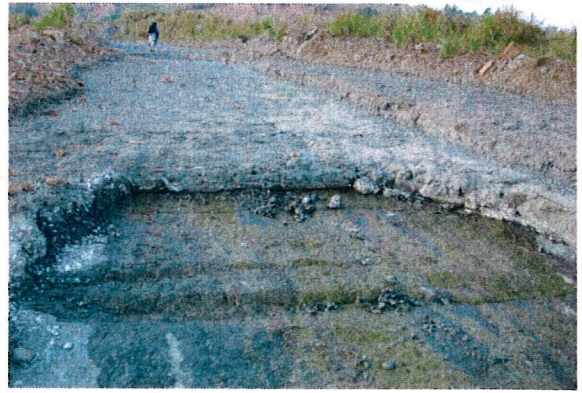
写真 5-11 九分二山の大規模崩壊に見られる層理面の浮き上がりによるすきま (2004年12月27日撮影)
