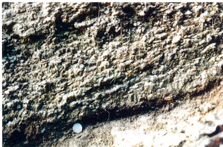
写真 2-2 崩壊から残された風化花崗岩中に発達しているシーティングジョイント
