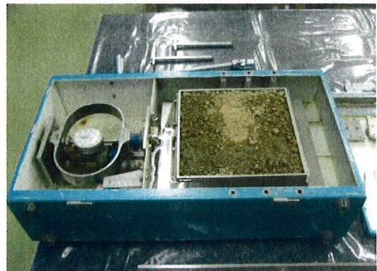
写真 4-2 せん断箱ごと水浸させる場合
