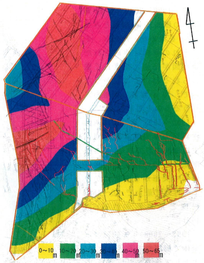
図 1-5 掘削深さ領域分布とクラック発生状況
