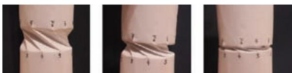
写真-3 折り紙スキルによる円筒構造体の折畳み原理と対称性破れ現象の一例
