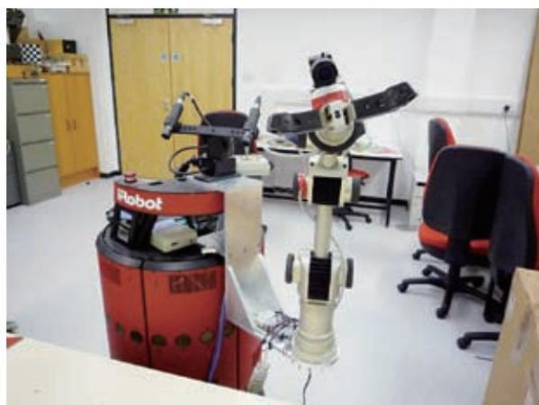
写真6：音声命令を理解して動作するロボット
