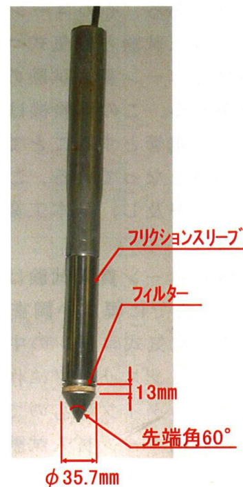
図 3-1 一般的な電気式コーン試験機
