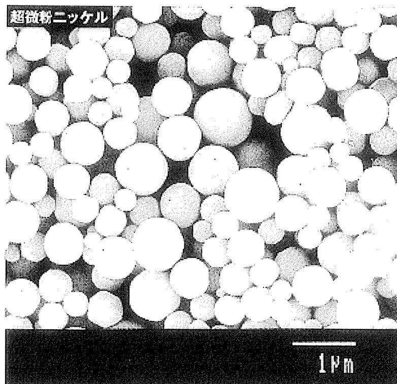
Fig.1-12 気相化学反応法 Ni 粒子 (JFE ミネラル株式会社資料)
