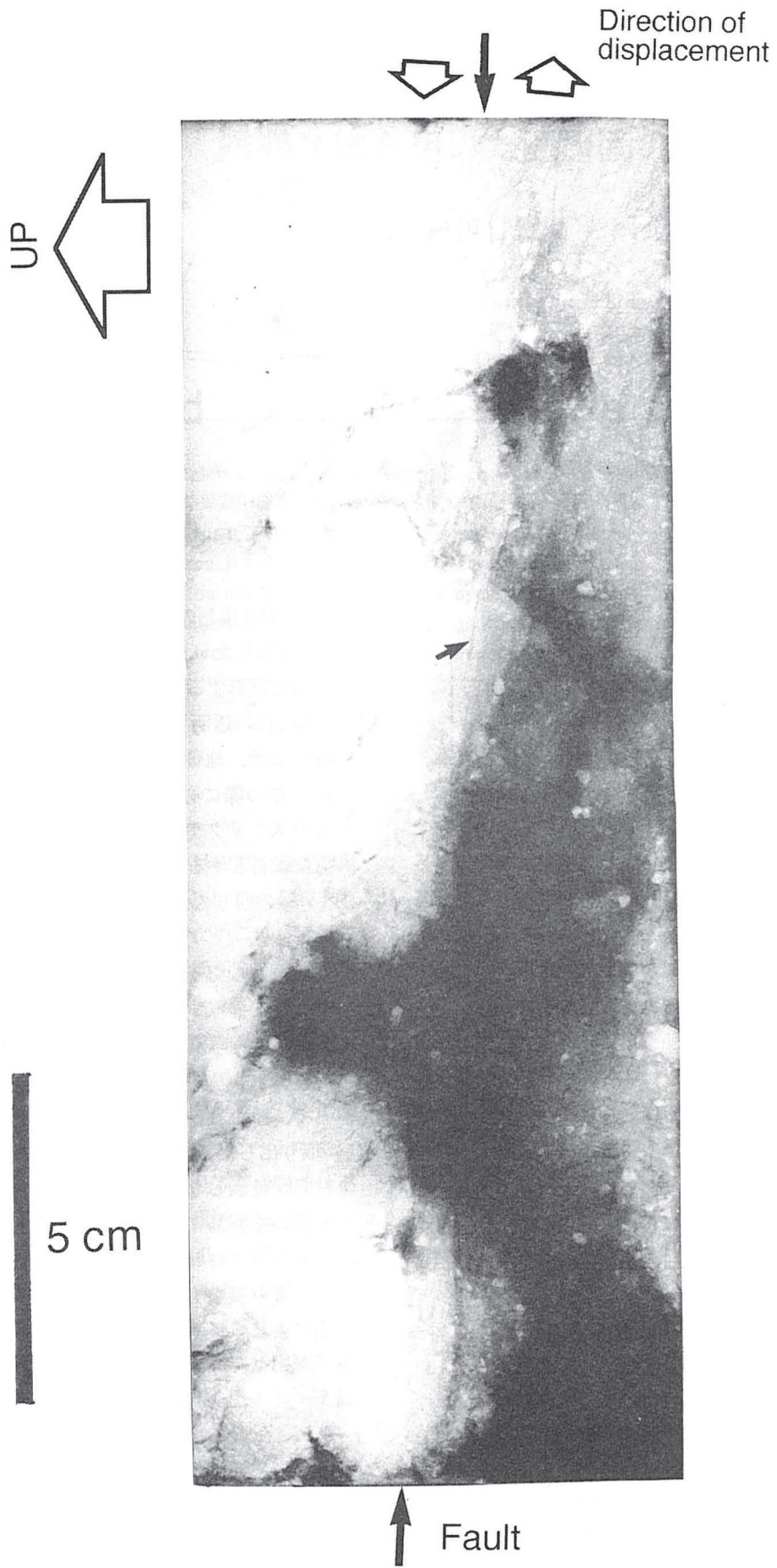
第3図 神城トレンチ北壁面で採取した低角逆断層の透過線写真（試料A）
