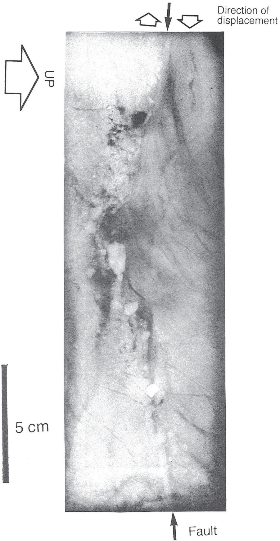
第4図 神城トレンチ南壁面で採取した低角逆断層の透過線写真（試料B）
