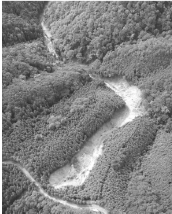
写真－2 道路近くに発生した土石流の事例（安芸太田町） （2006年9月16日発生，18日撮影）
