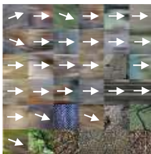
図9 T=100 ブレ領域拡大図 (ブレ方向を矢印で表示)
