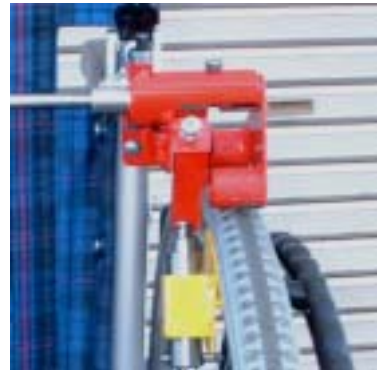
図5 速度センサーピストンおよびブレーキフック部
