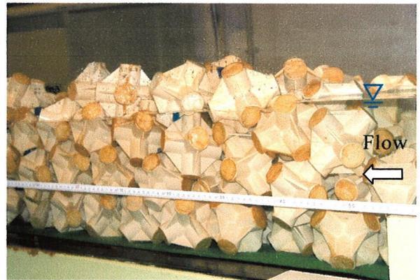
写真-4.2 抗力係数  $C_D$  測定実験の様子
