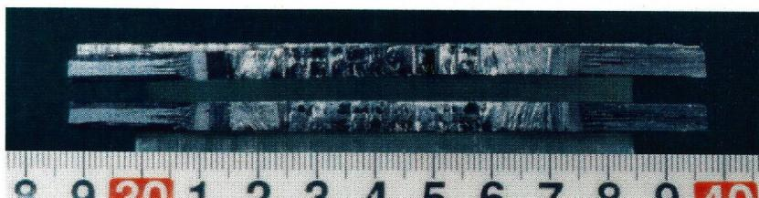
SC-7, Fatigue-cracked Notch, Temp. :  $-196^{\circ}\text{C}$
