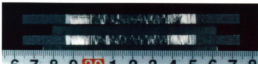
CC-7, Machined Notch, Temp. :  $-196^{\circ}\text{C}$
