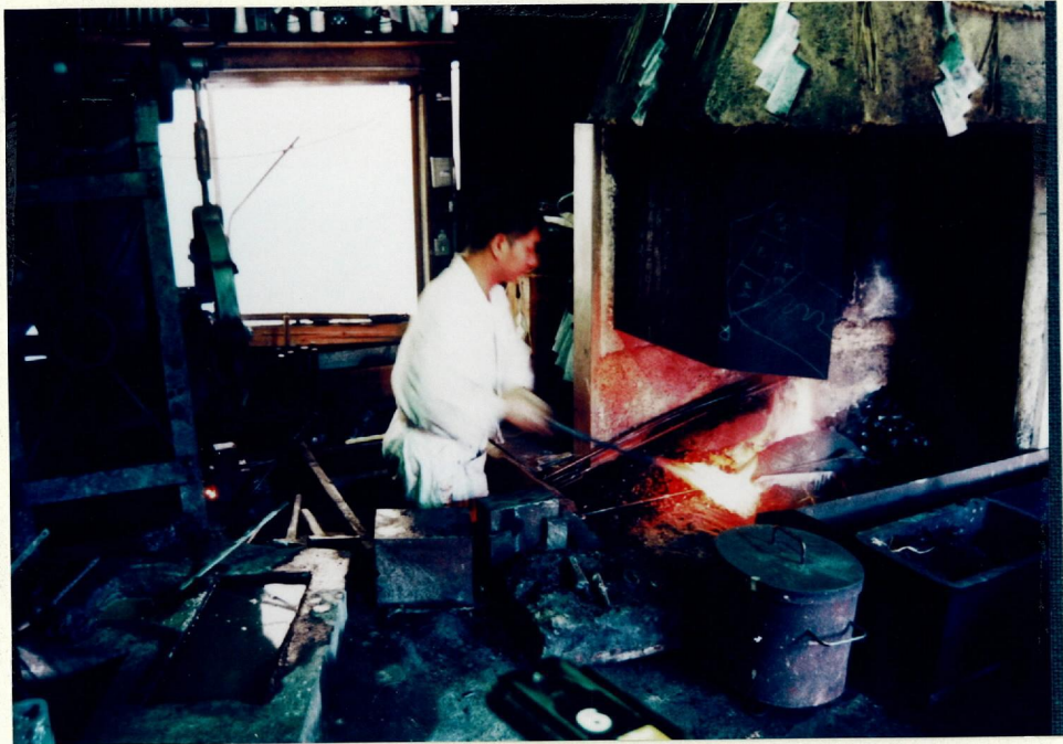
a 沸し（折り返した素材を沸して鍛錬する）
