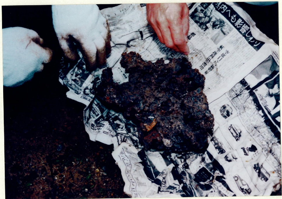
b 実験炉で生成した粗鉄
