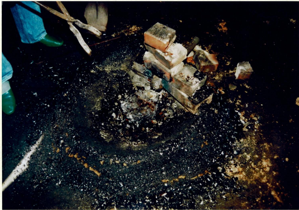
a 鍛冶実験炉の操業終了と生成した卸し鉄
