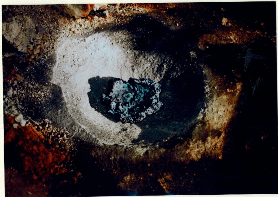
b 鍛冶実験炉の炉底の状況と生成した卸し鉄
