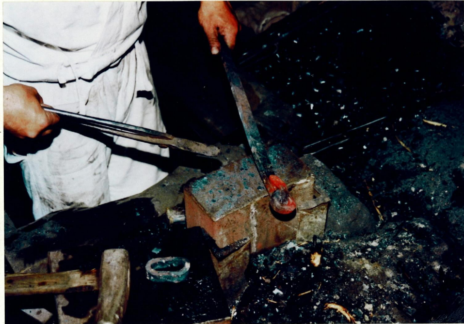
a 素環部の鍛接（茎端巻き込み法）
