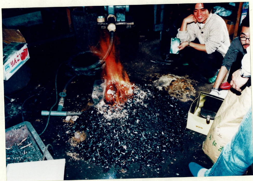
b 卸し技法による鍛冶実験炉の精錬鍛冶操業
