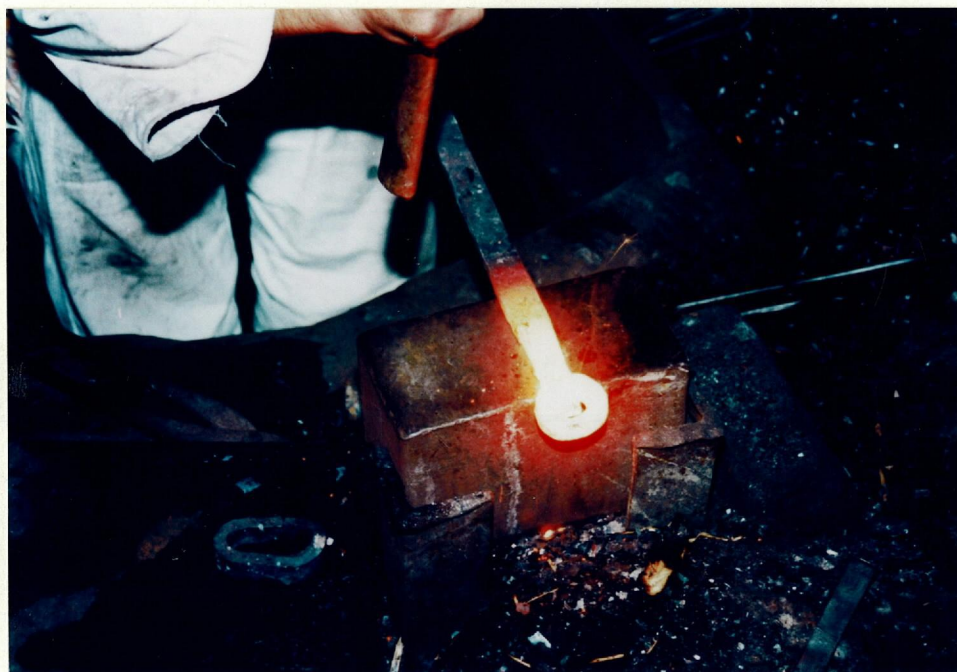
b 素環部の沸し付け（研砂使用の鍛接）
