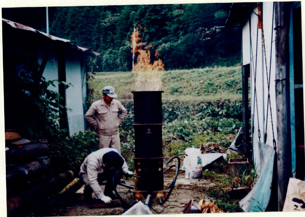
a 実験炉による砂鉄精練
