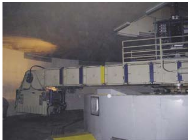
写真8 UCSDにある遠心載荷装置（半径約9.1m）
