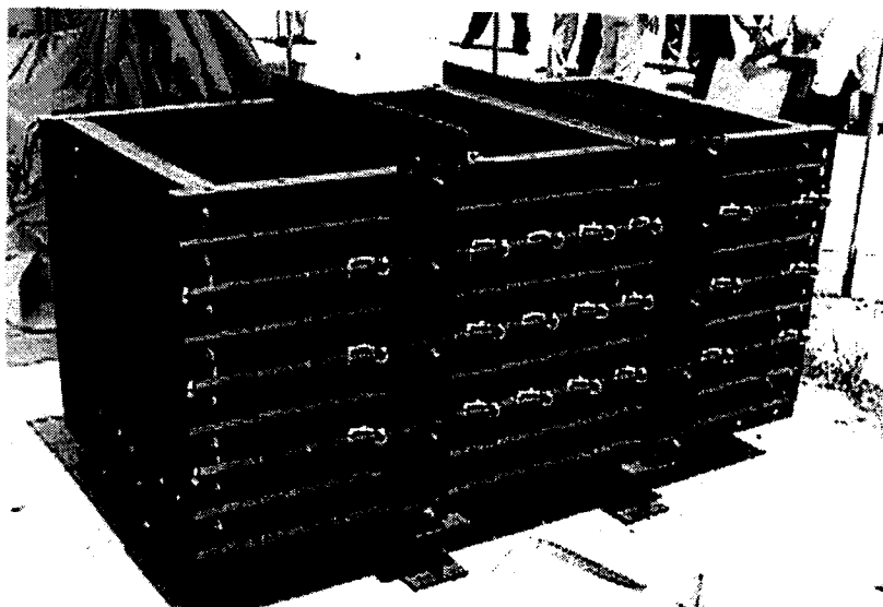
写真 3-1 使用した鋼製型枠
