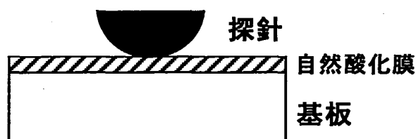
図2.2 SCMの測定原理
