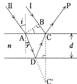
入射角  $i$  で、屈折率  $n$  ( $n > 1$ )、厚さ  $d$  の薄膜に入射する平行線があり、点  $A$  で屈折し膜の底面  $D$  で反射した後点  $C$  から出てくる光と入射角上の点  $C$  で反射する光が干渉する様子を調べてみよう。
