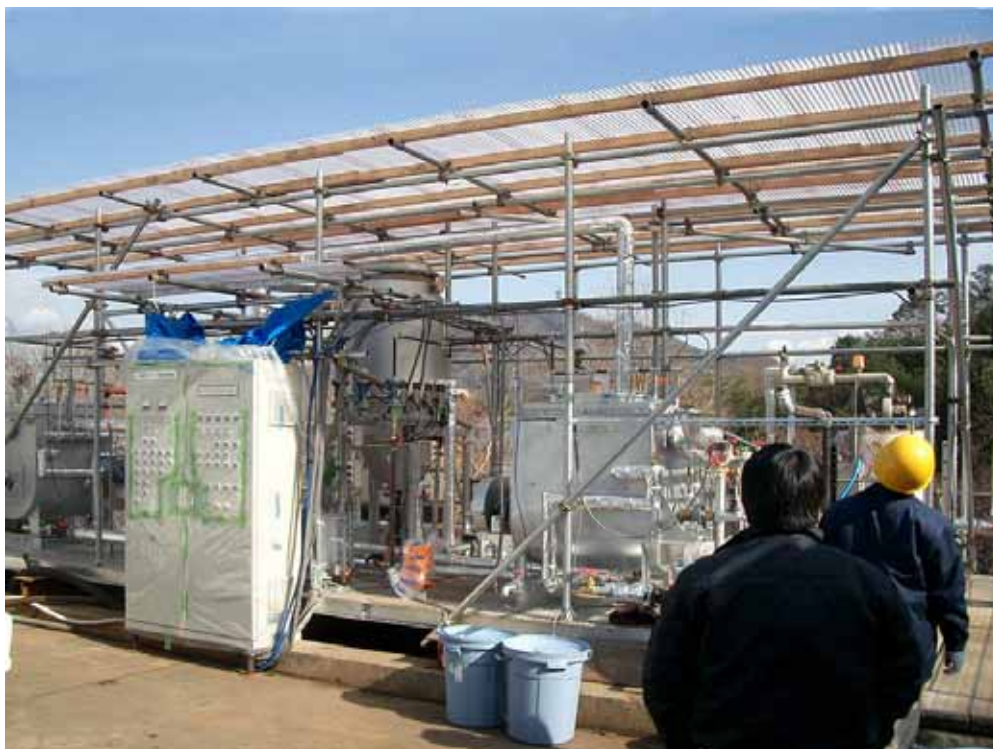
図3・19 アンモニア発酵・脱アンモニアベンチリアクターの設置状況
