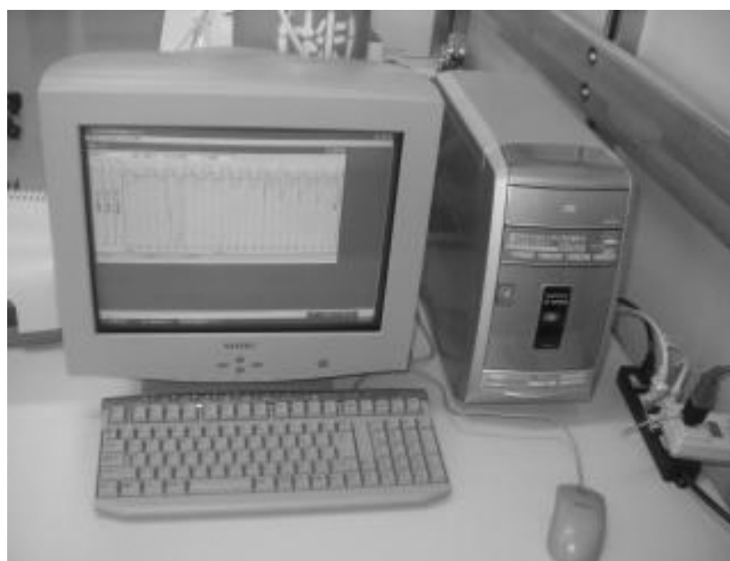
図3-7 温度・湿度コントロール用コンピュータ
