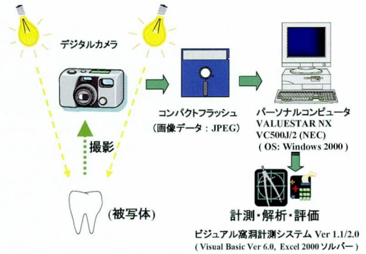
図1 本研究で採用したデジタルカメラを用いた計測システム
