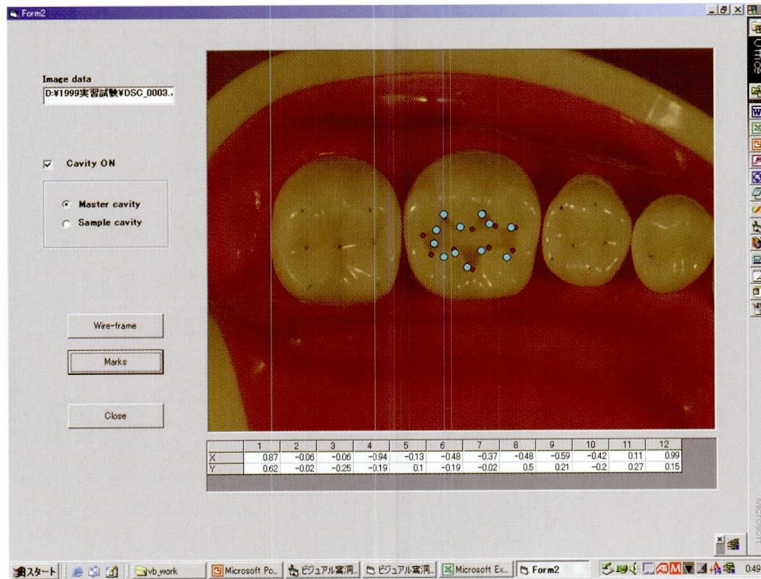
図9 計測結果の『ビジュアル窩洞計測システム』上での表示 図に示される赤い点はマスター窩洞に定義した計測点を示し、図に示される青い点は一学生の形成した一窩洞の相対する計測点を示す。
