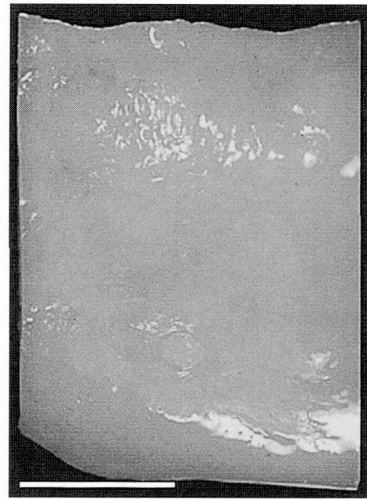
図1 対象とした下顎骨無菌顎部。 高さ約20 mm, 近遠心幅径約15 mmの無菌顎部を近遠心が平行となるようトリミングし、無菌顎骨ブロックとした(—:5 mm)。
