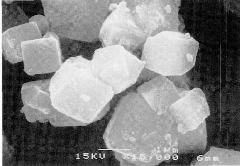
図1 SZの走査型電子顕微鏡写真（倍率×15,000）。
