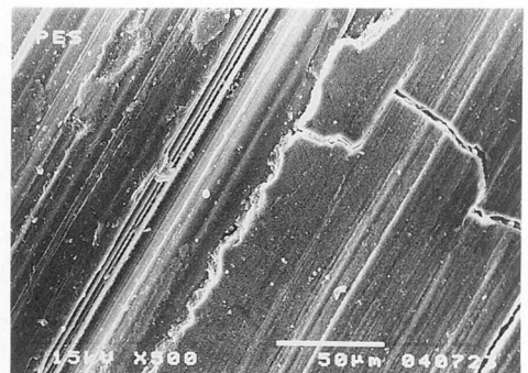
図23 下部試料 PES の摩擦面(×500, 上部試料が HR の場合)。
