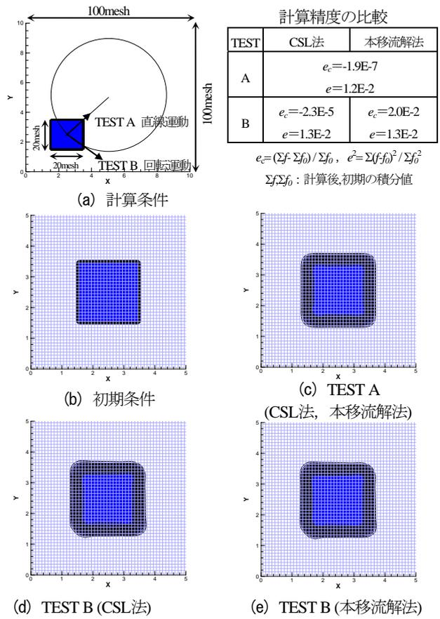
図-3 正方形波形の輸送計算精度の検証
