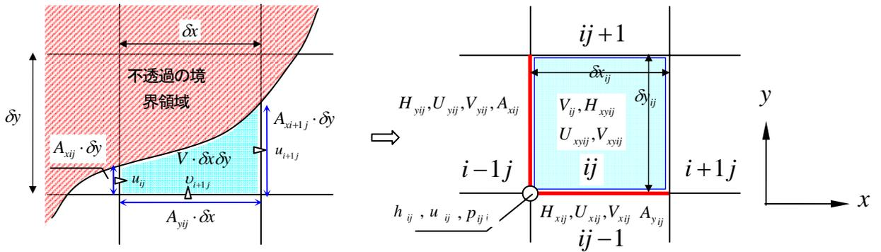
図-1 不透過の境界領域を空隙率で表現したコントロールボリューム(左)と本解析における主要な変数の配置(右)
