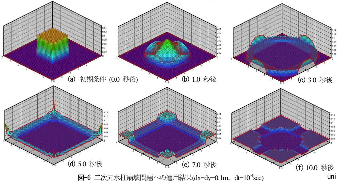
図-6 二次元水柱崩壊問題への適用結果(dx=dy=0.1m, dt=10<sup>-4</sup>sec)
