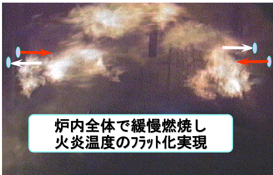
Photo. 3-2 高温空気燃焼バーナ火炎
