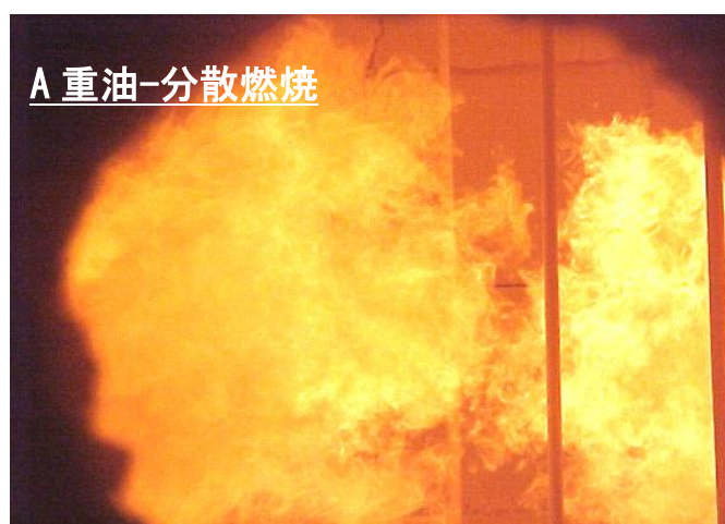
Photo. 3-4 各種燃料・燃焼方式での火炎の状況（炉温=1250℃）
