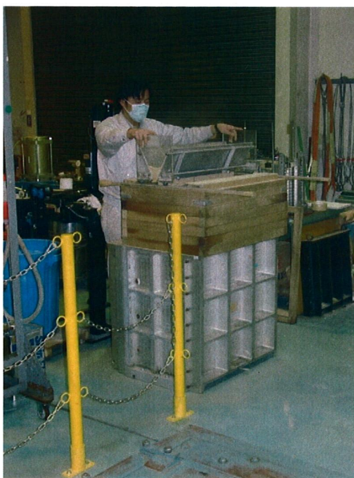
写真 3.2 空中落下法による地盤の作製状況
